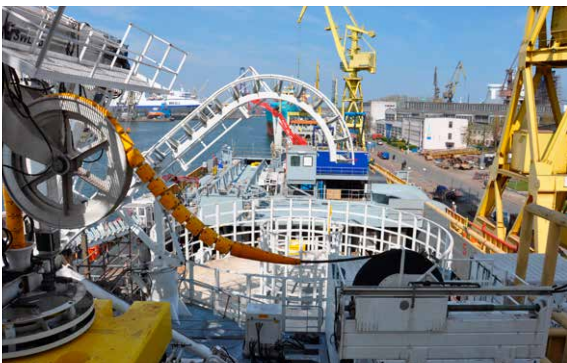
Tak wygląda pokład statku przebudowanego na kablowiec. Fot: Jerzy Uklejewski
